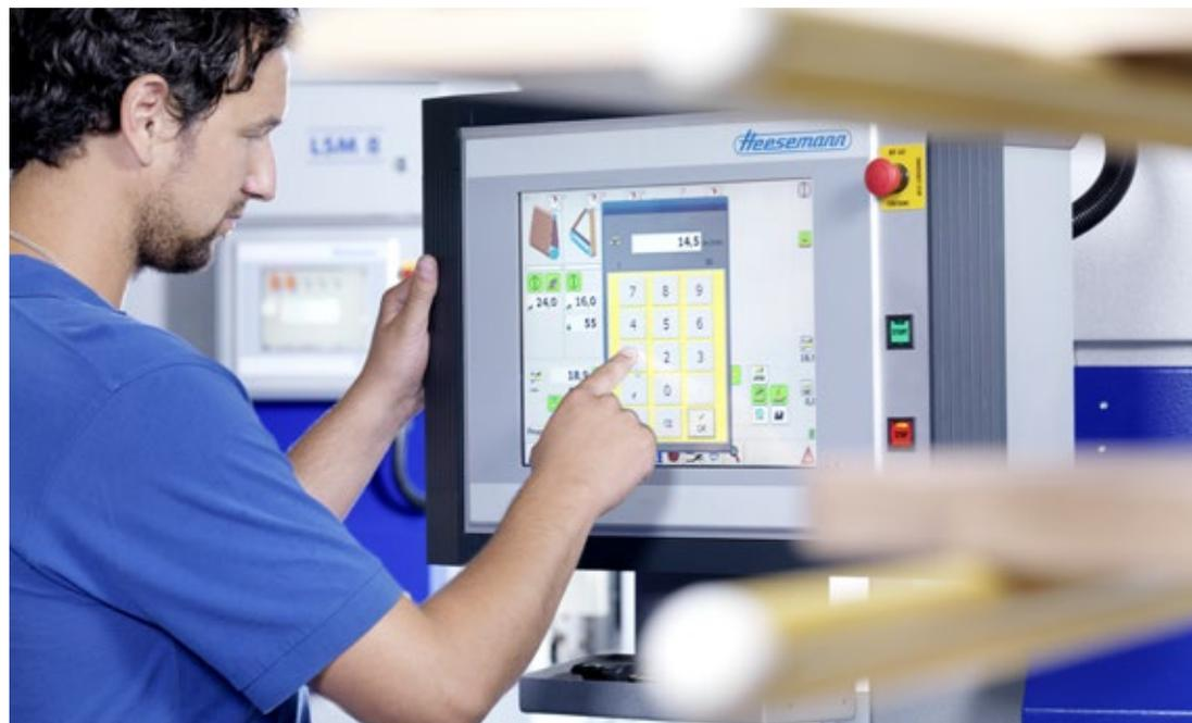
*Über einen Schwenkarm kann der Industrie-PC zum Maschinenbediener bewegt werden.*
