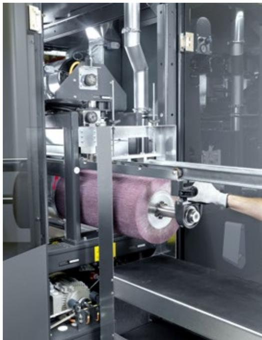
*Ein Wechsel der Bürstenwalzen kann dank der Schnellwechsellvorrichtung innerhalb weniger Minuten durchgeführt werden.*
